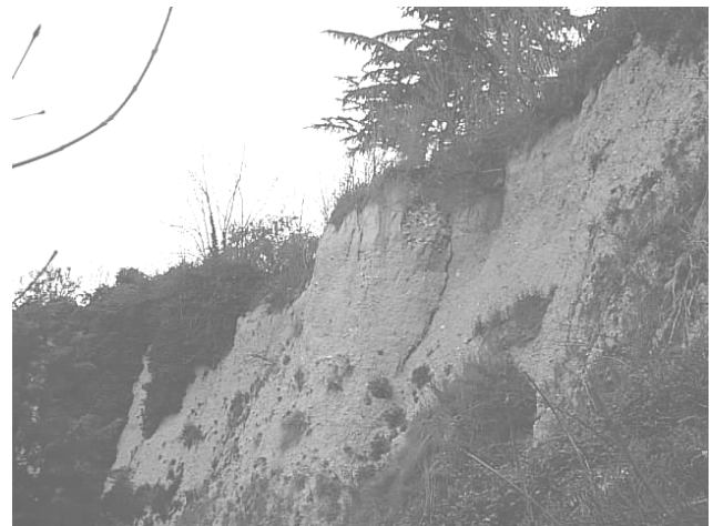
Figura 7. Fratture di trazione sulla scarpata bordante il settore meridionale della località Nocella (sito B).
